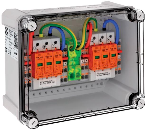
Generatoranschlusskasten Typ 1+2 für Photovoltaikanlagen zum Anschluss von 2 x 2 Strings. Zum DC-Schutz des Wechselrichters.
