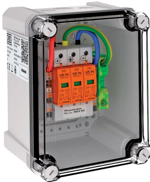
Generatoranschlusskasten Typ 1+2 für Photovoltaikanlagen zum Anschluss von 1 String. Zum DC-Schutz des Wechselrichters.
