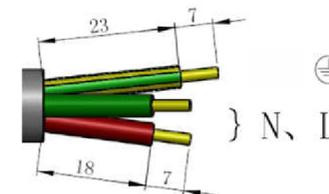
Abbildung 4.15 Abgelöste AC-Drähte
