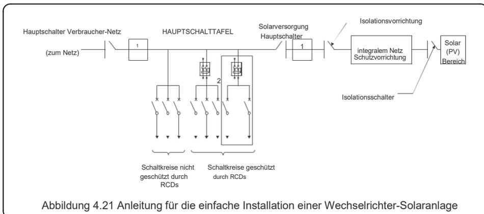
1. Der Fehlerstrom-Schutzschalter (RCD) sollte in Parallelschaltung zwischen dem Verbrauchernetz und der Solarversorgung liegen.
