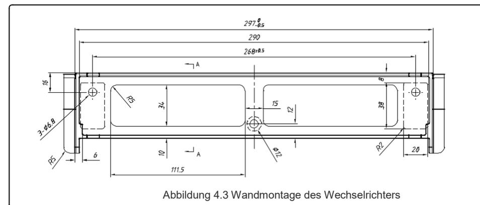
Abbildung 4.3 Wandmontage des Wechselrichters
