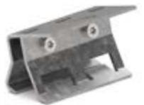
**HINWEIS:** Das Anzugsdrehmoment ist so zu begrenzen, dass die Blechfalze nicht verformt werden und die thermische Dehnung der Bleche nicht verhindert wird. Insbesondere bei Titanzinkblech ist die Profillänge auf 3 m zu begrenzen.
