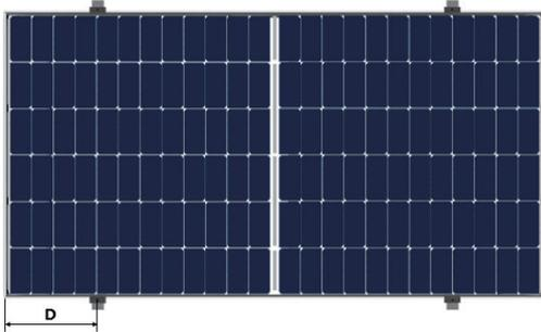
Installation eines gerahmten Moduls mit Befestigungen
