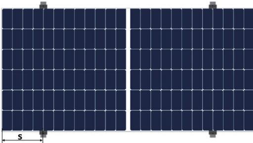
Installation eines gerahmten Moduls mit Befestigungen
