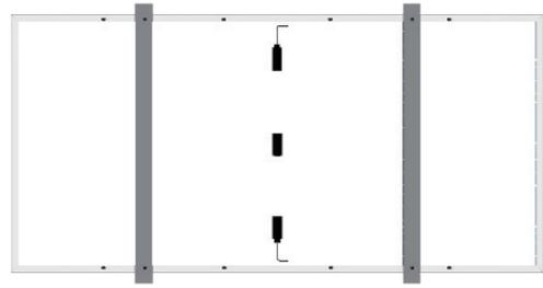
Einbau mit Schrauben in 4 innere Löcher
