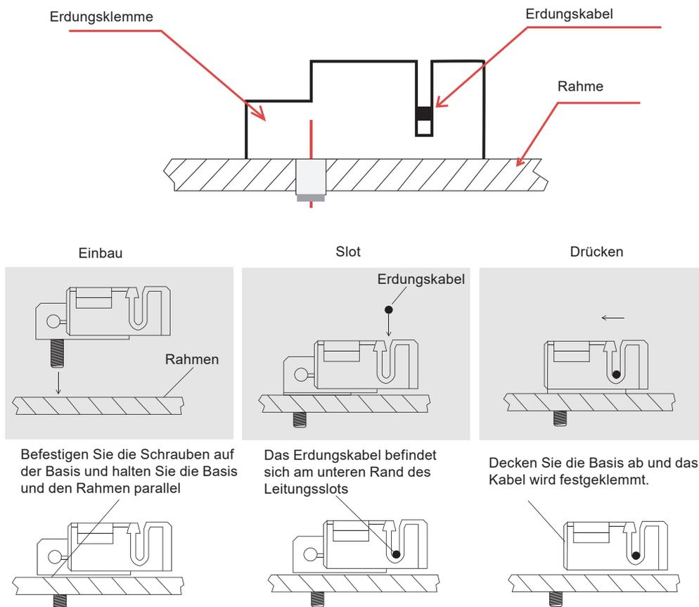
Abbildung 11 Installationsmethode der Erdungsklemme
