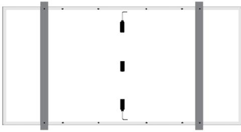
Einbau mit Schrauben in 4 äußere Löcher
