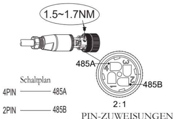
Führen Sie das Kabel in dieser Reihenfolge durch die Mutter (g), den Dichtungsring (h) und die Hülse (i). Die Mutter (g) auf die Hülse (i) schrauben (noch nicht festziehen), dann den Rohrkabelschuh (M) in den Stecker (j) des DC-Anschlusses einsetzen und die Schraube festziehen.
