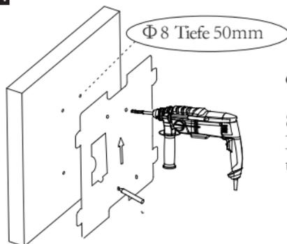
1. Markieren Sie 4 Löcher gemäß der Installationskarte an der Wand.
