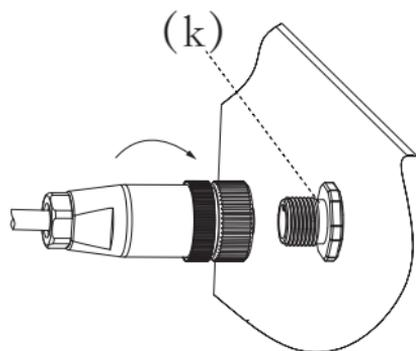
Stecken Sie den Stecker (j) des DC-Anschlusses in die Buchse (k) der Anschlussdose und ziehen Sie den Stecker (j) fest, um die Installation abzuschließen.
