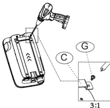
Befestigen Sie die Halterung (C) mit den Schrauben (G) an der Wallbox.
