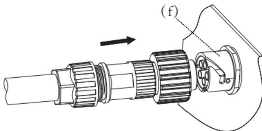
Stecken Sie den Stecker (d) des AC-Anschluss in die Buchse (f) der Anschlussdose und ziehen Sie den Stecker (d) fest, um die Installation abzuschließen.
