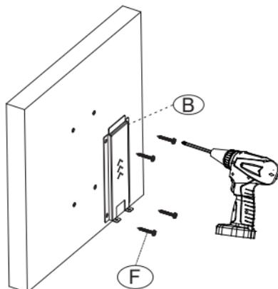
Befestigen Sie die Montageplatte (B) mit Schrauben (F) an der Wand.
