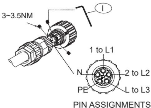
Installieren Sie das Kabel in den Stecker (d) des AC Anschluss, wie in der Abbildung unten gezeigt, und ziehen Sie die Schraube mit einem 2mm Inbusschlüssel (I).
