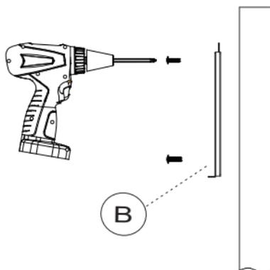
Befestigen Sie die Montageplatte (B) mit Schrauben an der Säule.
