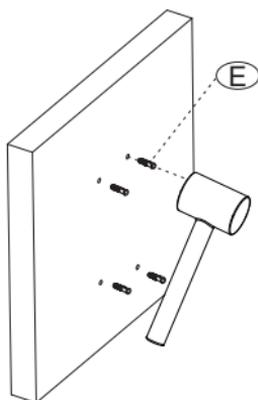
Stecken Sie das Expansionsrohr (E) in das Loch und fixieren Sie es mit einem Gummihammer.
