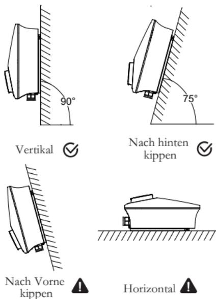
Schematische Darstellung der Installation
