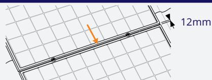
**⚠ Achtung:** Vergewissern Sie sich, dass der Abstand 12 mm beträgt und dass die Solarmodule gerade sind, bevor Sie die Schraube anziehen.
