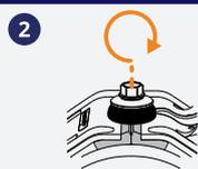
2. Schraube fest anziehen, bis die EPDM-Dichtung des Bügels auf die Gumdichtung der Schraube trifft.
